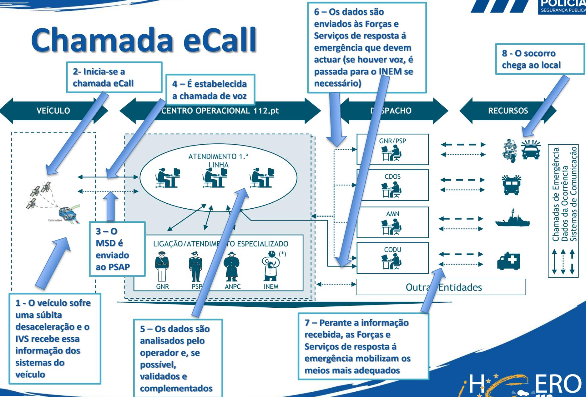
**1 - O veículo sofre uma súbita desaceleração e o IVS recebe essa informação dos sistemas do veículo**
